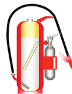
EXTINTOR DE PRESIÓN ADOSADA (BOTELLÍN EXTERIOR)
